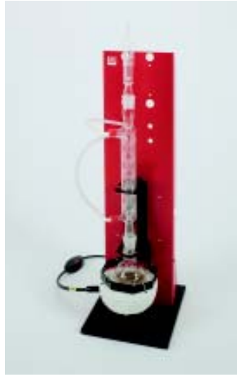
KSMA: Aqua regia digester for heavy metal samples
